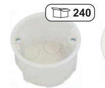
KM-215 Коробка для крепления изделий, согласно евростандарту. Расстояние между распорными лапками 55...65 мм D 70 мм; h 41,5 мм
